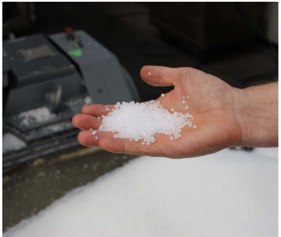
Granulat ist der Grundstoff für die Netze.
